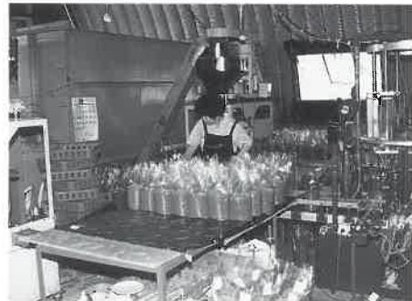
ホダ木のオガコを自動充填する作業
